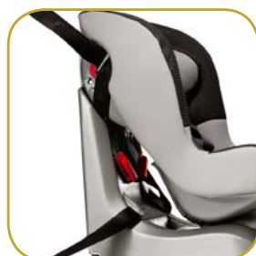
Key 1 Isofix também pode ser instalada num automóvel que não dispõe do sistema Isofix, utilizando o cinto de segurança do mesmo
